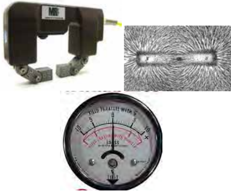
Resim 11: Manyetik Kontrol Ekipmanları ve Manyetik Akım Basit Gösterimi
