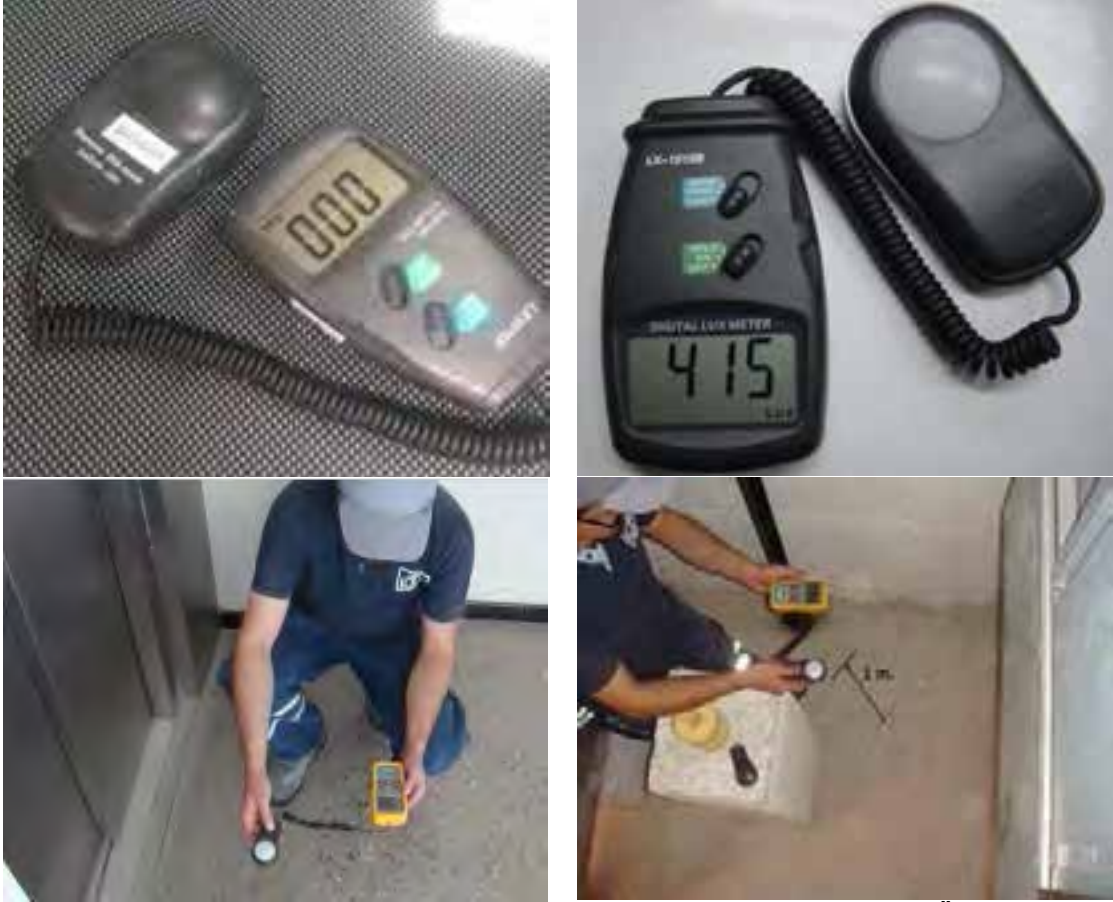
Durak Kapısı Önü Aydınlatma Ölçümü
