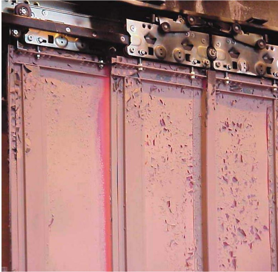
Şekil 4: Asansör Kat Kapısı Yangın Testi – Yüzeyler
