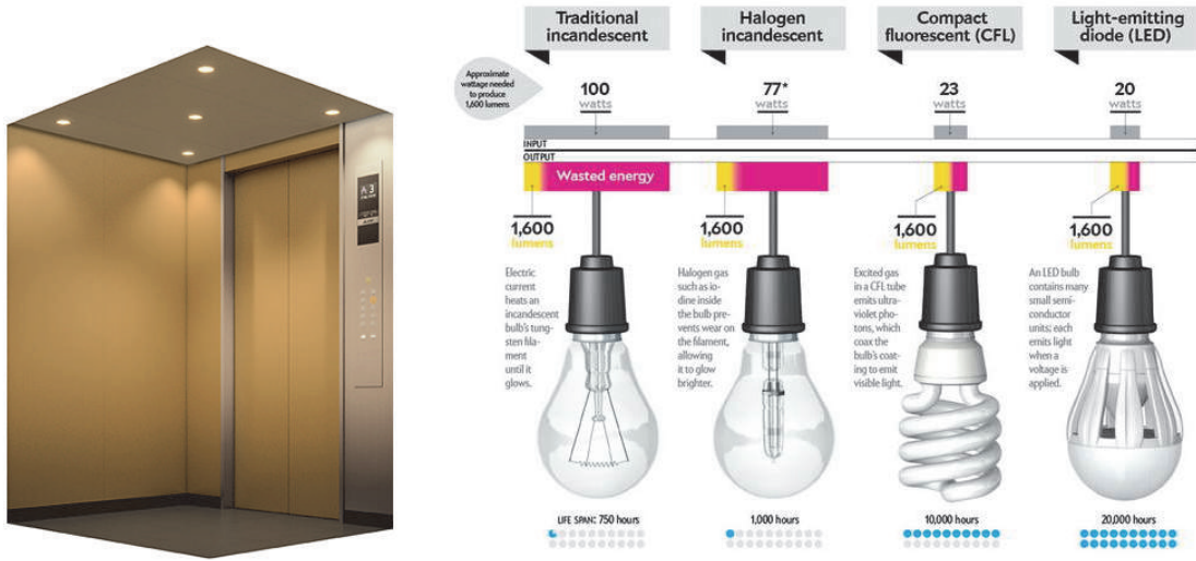
Şekil 3. Asansör kabin aydınlatmaları
