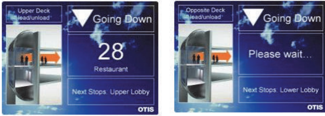
Şekil 5. Çift katlı asansörlerde bulunan kabin içi bilgilendirme ekranları
