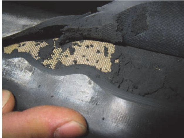
Şekil 5. Kauçuk kaplama siyah toz halini almış
