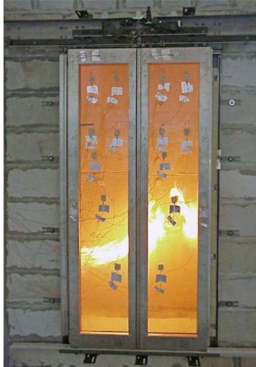
Şekil 1: Asansör Kat Kapısı Yangın Testi
